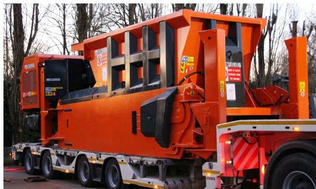
Cisaille transportable par camion semi-remorque
